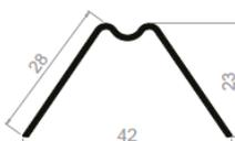
Clip de finition compatible pour grillage avec picot de 20 à 28 mm.
