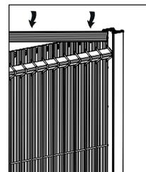
Disposez le clip de finition en haut du panneau face plane extérieure chantier afin de verrouiller vos lames.
