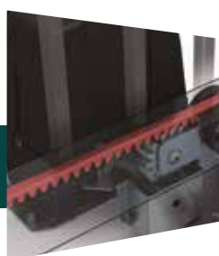
Crémaillère soudée dans la poutre
